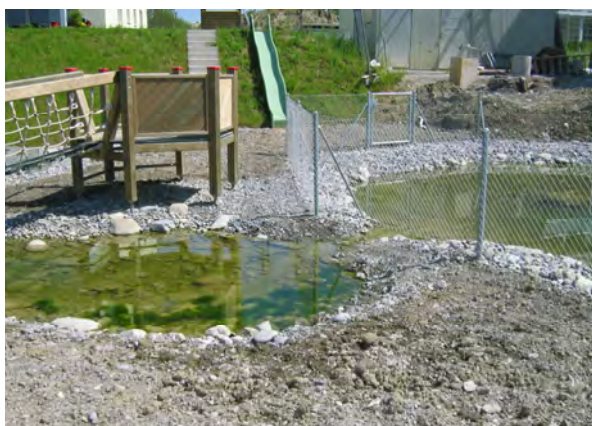
Illustration 3 Subdivision d'une pièce d'eau en un «étang de jeu» et un étang plus profond sécurisé par une clôture
