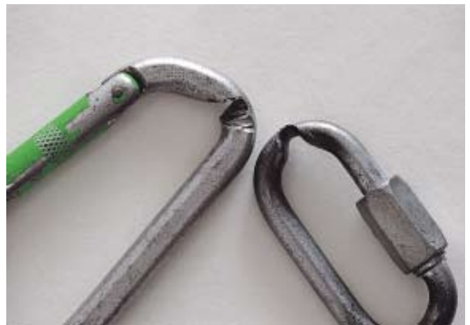
Abgenützte Sicherungsgeräte sofort ersetzen
